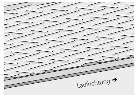
Vertikale Noppenstruktur (VN) mit geschälter Bandkante (M 1:5)
